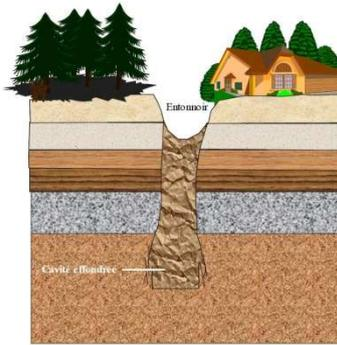
Figure 34 - Schéma d'un fontis
